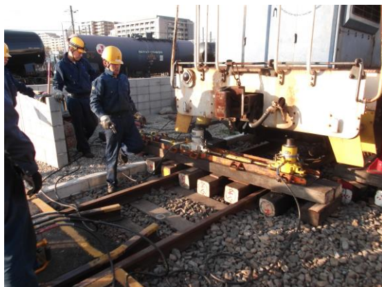
脱線した機関車をジャッキで持ち上げて横移動し、レール上に載線させる機関車脱線復旧訓練
